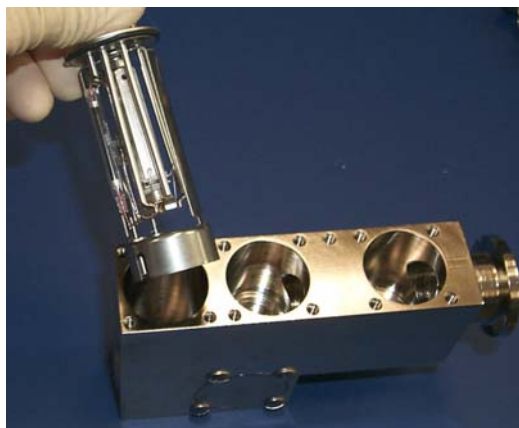
Schéma 4-16 Enlèvement du préamplificateur
