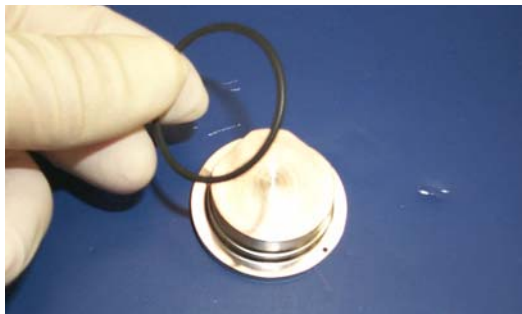
Schéma 4-18 Enlèvement du joint torique de la pièce du pôle magnétique
