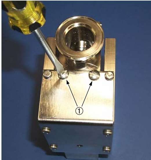
Schéma 4-7 Vis à fente de l'ensemble aimant
