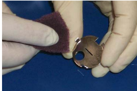
Schéma 4-20 Plaque à fente mise à la terre décolorée
