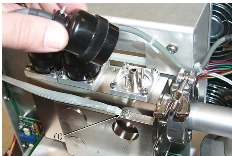
Schéma 4-3 Enlèvement des connecteurs
