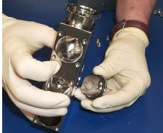
Schéma 4-19 Enlèvement de la deuxième pièce du pôle magnétique
