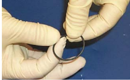
Schéma 4-23 Inspection des joints toriques
